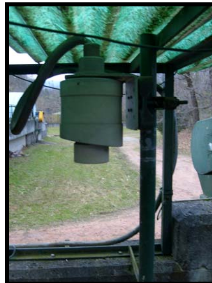
4 Sensore di misura portata
